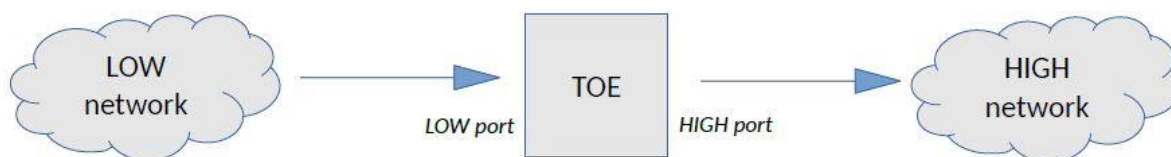
شکل ۱: معماری سطح بالا از Data Diode
